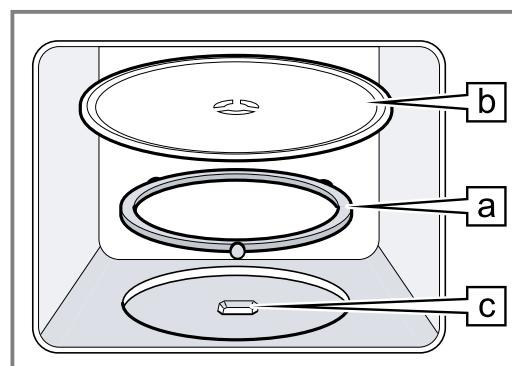
2. Вставьте вращающуюся подставку **b** в приводной механизм **c** посередине дна рабочей камеры.
