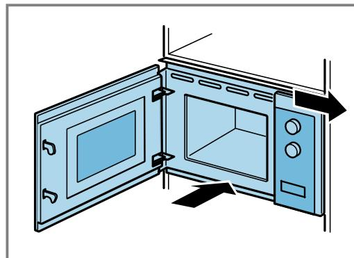
3. Dokręcać urządzenie, aż zostanie wyśrodkowane.
